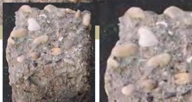
*deterioramento progressivo per cicli di gelo e disgelo*
