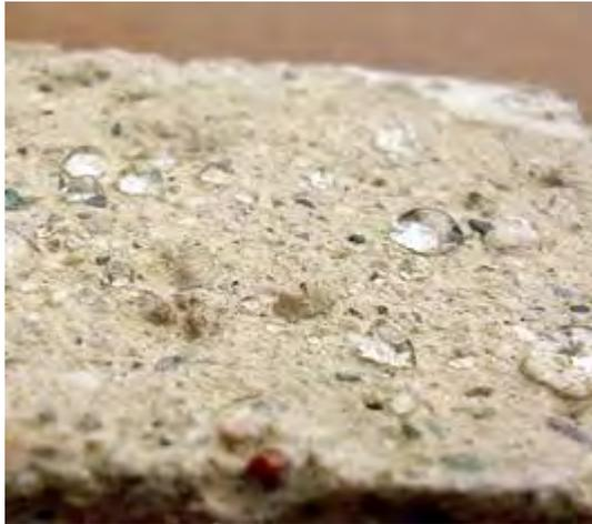
Sistemi atti ad ottenere una superficie idrorepellente non formanti pellicola (idrofobizzanti), ad esempio silani o silossani, o in grado di formare una pellicola sottile (impregnanti), ad esempio i polimeri organici.
