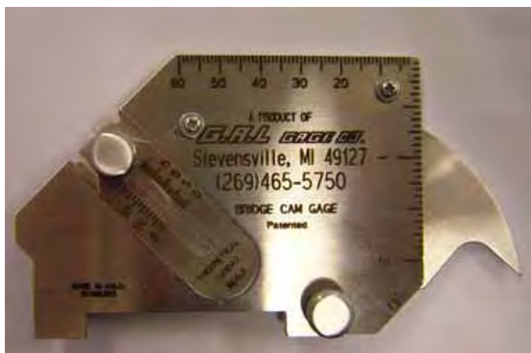
calibro per il controllo geometria delle saldature - Esame visivo
