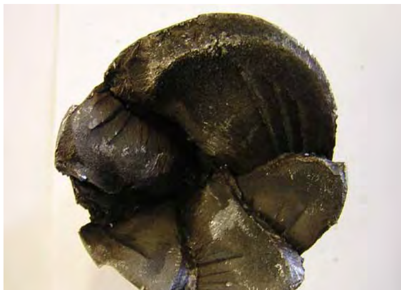
superficie di frattura di un albero rotante sollecitato a torsione
