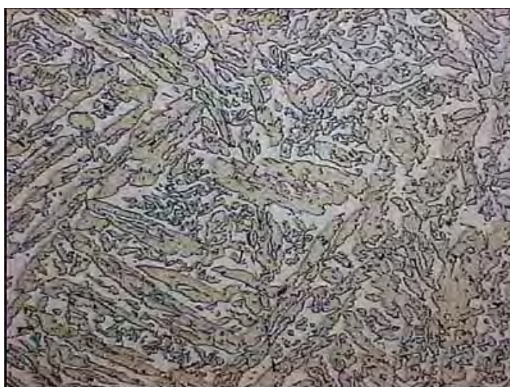
micrografia acciaio inox superduplex (austenite + ferrite)
