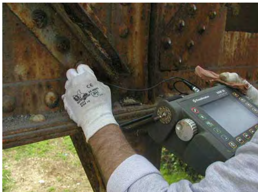
controllo ad ultrasuoni dei chiodi di unione di un ponte metallico
