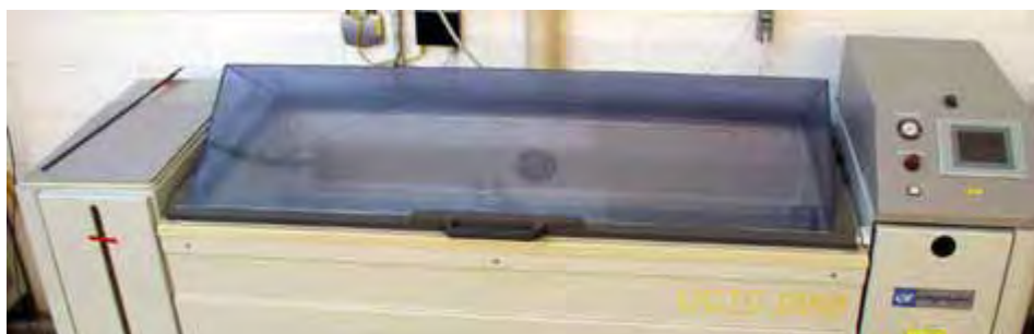
macchina per le prove di corrosione in nebbia salina, salino-acetica, cupro-salino-acetica
