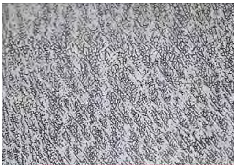
micrografia zona fusa su saldatura in acciaio inox austenitico
