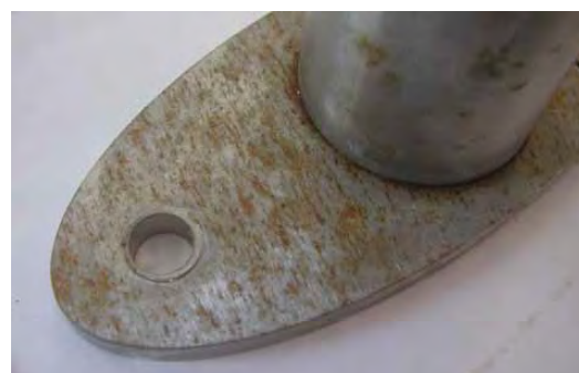
analisi corrosione su acciaio inox AISI 304
